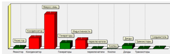
Рис. 7. Уровни эксплуатационной интенсивности отказов для каждого класса ЭРИ в режиме предельных нагрузок при температуре +60°C (класс подсвечивается красным цветом при превышении 5,86E-6 [1/ч])
