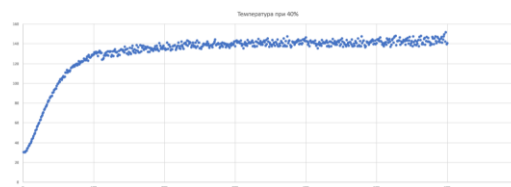
Рис. 3. Расчетная температура экструзии PLA пластика
