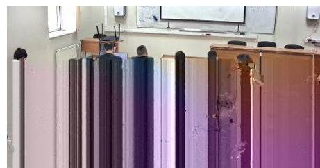
Рис. 2. Визуальный эффект от некорректной обработки входного потока прокси-сервером
