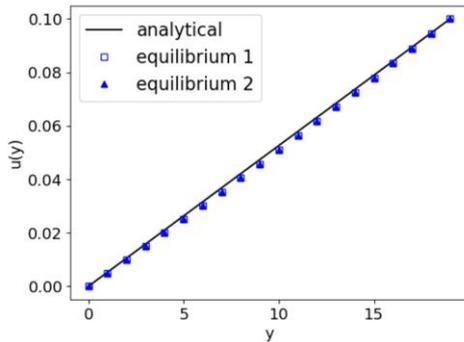
Рис. 4. Численное и аналитическое решения модельной задачи для *link-wise* метода учёта ГУ и разных равновесных функций распределения при  $\tau = 0.9$ ,  $N_t = 1000$  и  $u_0 = 0.1$ , ошибка  $err = 0.02$
