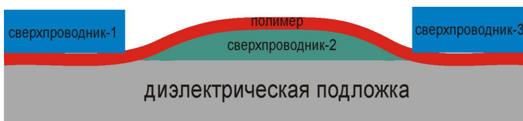
Рисунок 1.10. — Гетероструктура свинец – ПДФ – свинец в планарной конфигурации типа полевого транзистора [11].
