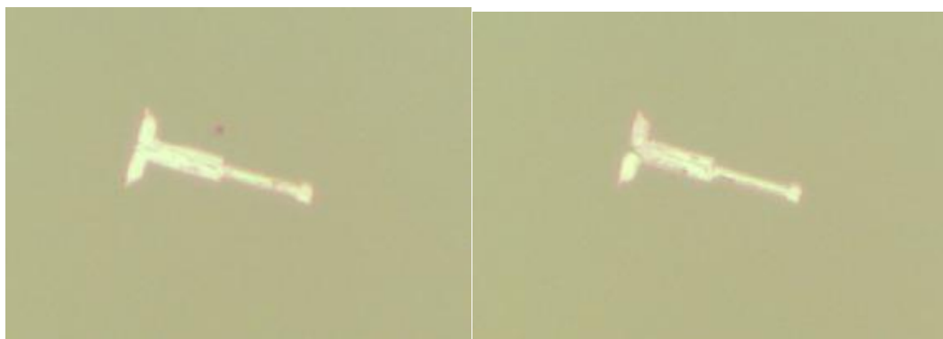
Рисунок 2.7. — «Вилочки» после напыления алюминия и снятия оставшегося резиста.
