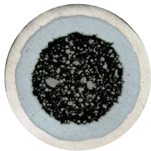
Одноволоконный сверхпроводник на основе легированного MgB_2
