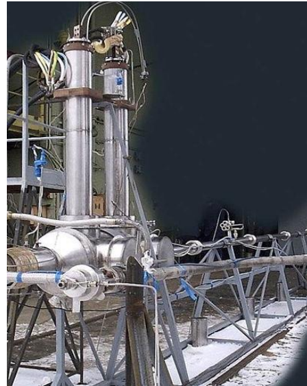
Гибридная энергетическая магистраль, состоящая из MgB_2 кабелей и рабочей температурой 20К (ВНИИКП)
