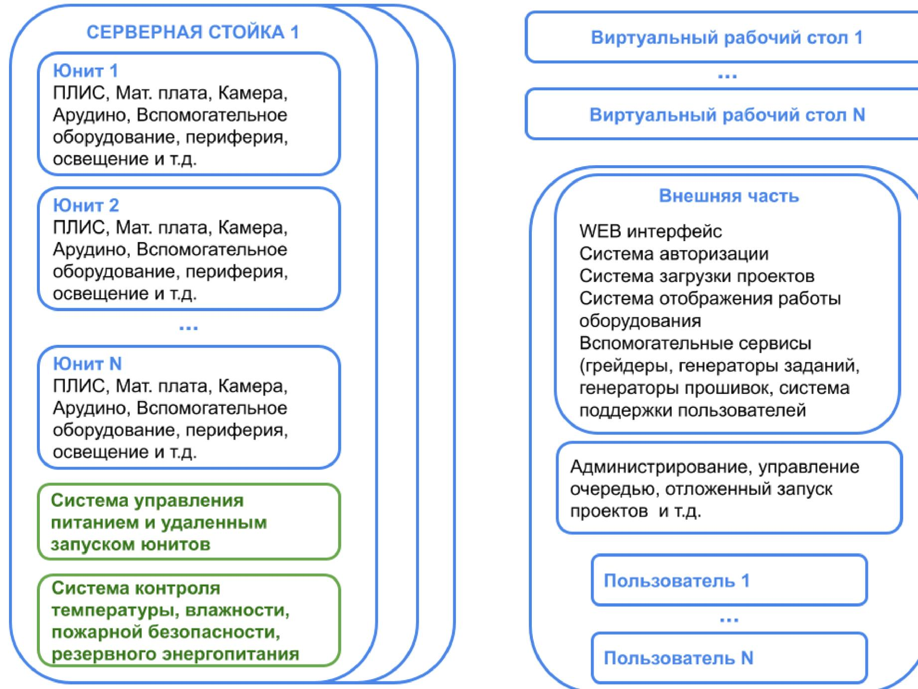
Схема работы лаборатории с синхронным режимом взаимодействия с оборудованием
