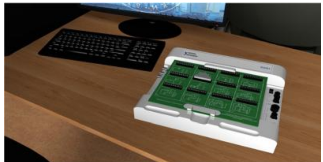
Рис.16. Корпус NI ELVIS II со схемой " Аналоговые элементы информационно-измерительной техники "
