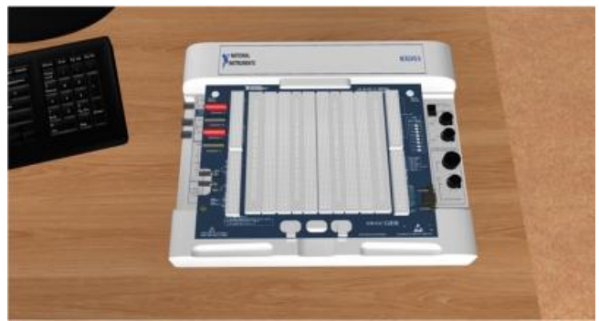
Рис.15. Корпус NI ELVIS II со схемой " NI ELVIS SERIES PROTOTYPING BOARD " .
