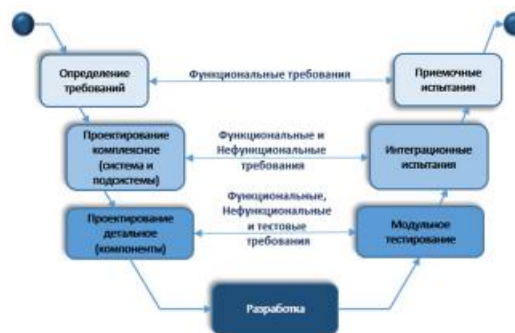
Рис.3. V-модель разработки программного обеспечения.
