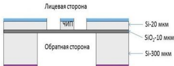
Рис.1. Схематичное изображение чипа в разрезе
