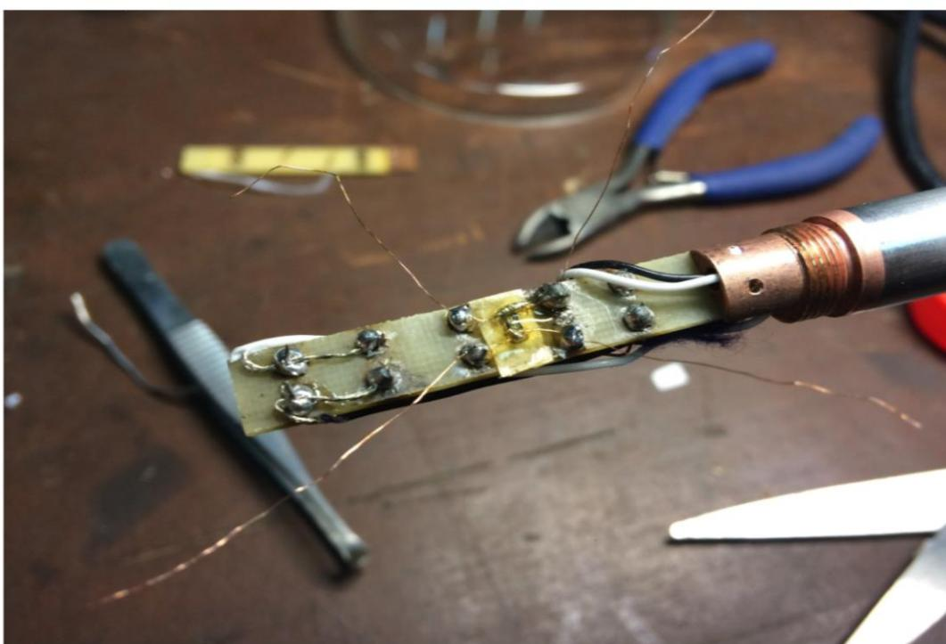
Обратная сторона площадки с уже припаянными проводами и прикрепленным термометром, готовая для помещения в защитную трубку
