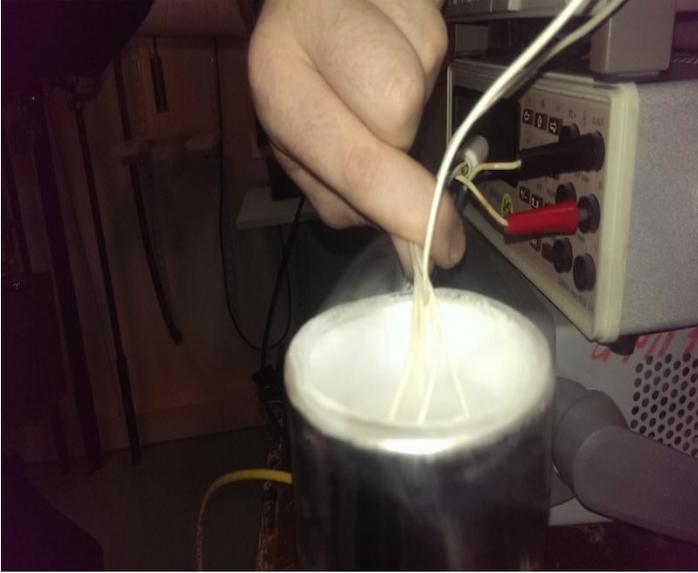
Рис.13: Диод, помещенный в жидкий азот
