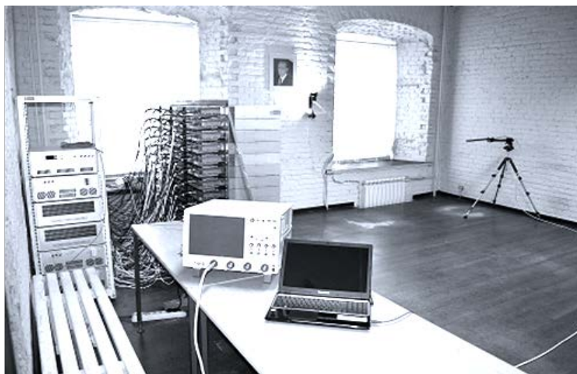
Рисунок 3 – Стойка питания и управления, излучающая система, осциллограф, ПК, преобразователь импульсного электромагнитного поля.
