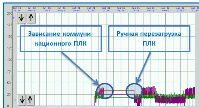
Рисунок 1 – Тренды распределения потребляемой объектом мощности в реальном времени (экранная форма АРМ диспетчера АСДУ)
