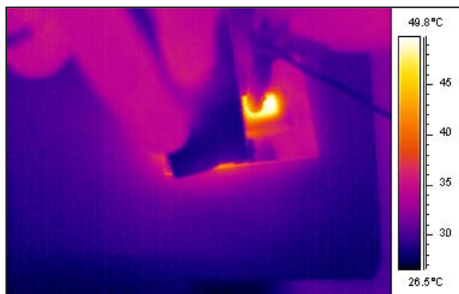
Рисунок 4 – Показания тепловизора при максимальной силе прижатия (транзистор)
