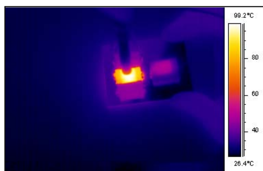
Рисунок 3 – Показания тепловизора при максимальной силе прижатия (резистор)
