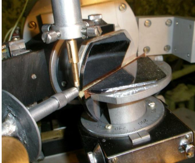
Рис. 8. Фотография блока увеличивающих кристаллов, коллиматора и гониометрической головки.
