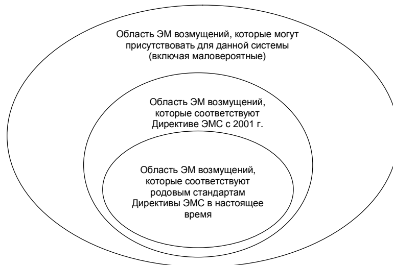
Рис. 3. Схематическое изображение охвата параметров ЭМО, в котором может работать электронное оборудование, с нормами стандартов и Директив
