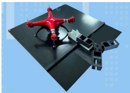
Рис.8. Станция быстрой замены аккумулятора дрона
