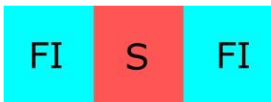
Рис. 1. Гетероструктура ферромагнитный изолятор-сверхпроводник-ферромагнитный изолятор
