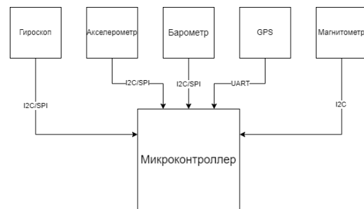
Рис. 1. Схема поддерживаемых интерфейсов программным обеспечением Betaflight [6]
