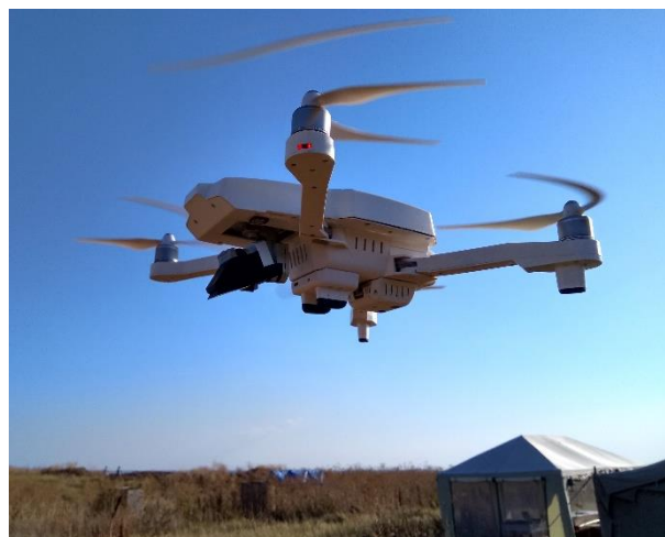
Рис.2. Общий вид. Полностью рабочий образец летающего спектрометра создан и проходит испытания. Спектральный модуль совмещен с камерой в передней части корпуса
