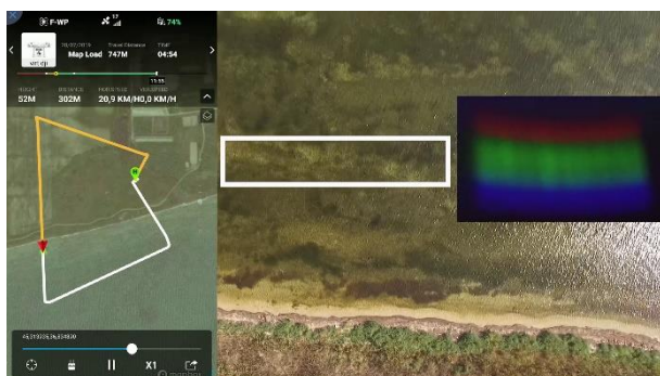
Рис. 4. Маршрут БПЛА, границы полосы обзора спектрометра и спектральная картина, формируемая участком внутри белого прямоугольника
